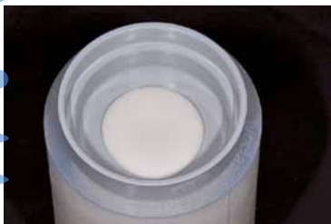
Насадить шаблон на муфель, чтобы верхняя и нижняя сторона оставались параллельными друг к другу.
