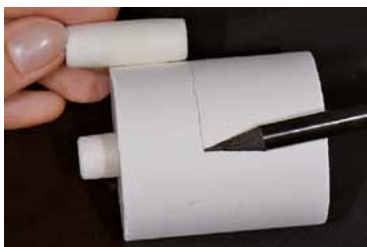
Маркировка длины поршня
