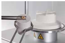
Ролинги VINTAGE LD Press закладывать в горячую опоку таким образом, чтобы этикетка с указанием цвета была сверху.
