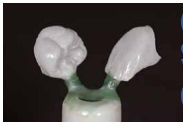
Установка литников в направлении тока керамики и в самой толстой точке восковой модели
