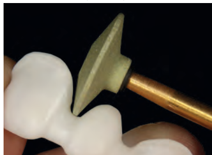
KN7: Обработка каркаса. Мягкая обработка межзубных и маргинальных областей и корректировка толщины стенок
