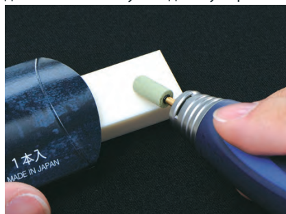
Для чистки и изменения формы обработайте абразив Dura-Green DIA корректировщиком Shofu (оксид алюминия), используя стирательные движения
